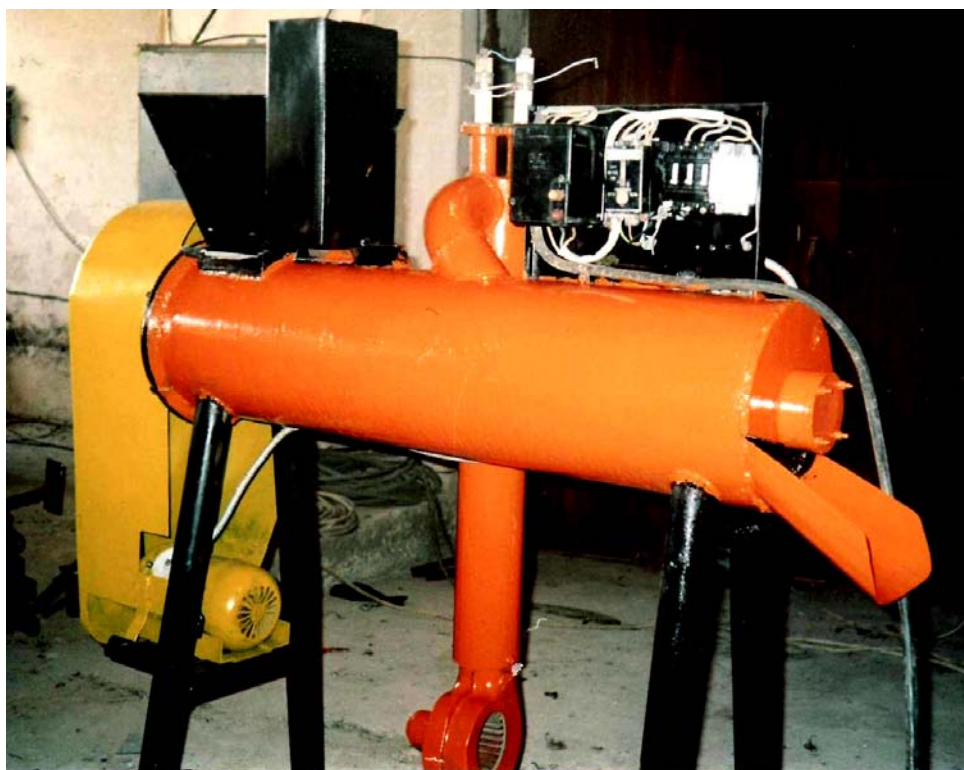
Eig. 10.3. Malaxor cu bare cu acționare continuă cu productivitatea orară Q = 900...1200 kg/oră
