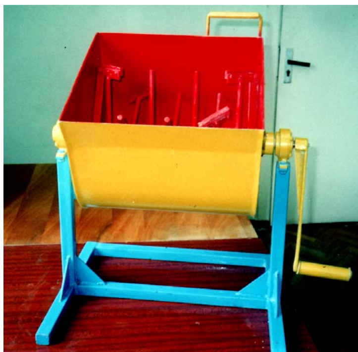
Fig. 10.2. Malaxor cu bare cu acțiune ciclică cu volumul amestecului preparat V_a = 10 \text{ dm}^3 . Producție S.A. INCOMAȘ
